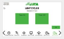
Ajustar el tiempo de inicio y finalizado de la luz.(Solo es efectivo en Modo automático) Adjust the starting time and ending time of the lighting.(Only it is effective when in Auto mode)
